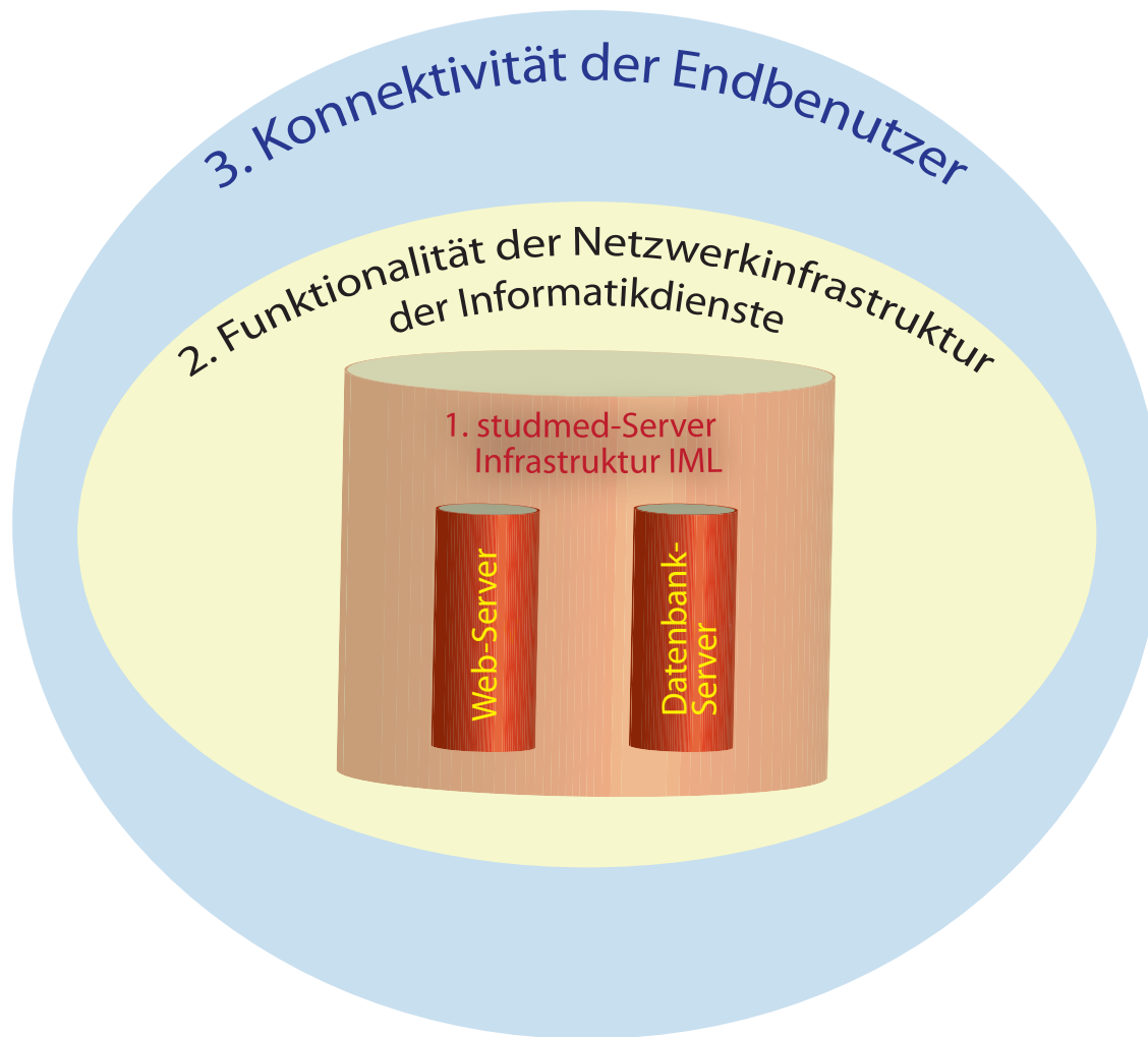
Abb. 18: Die Verfügbarkeit von studmed.unibe.ch aus Sicht der Endbenutzer hängt von drei Faktoren ab: 1. Verfügbarkeit der studmed-Server-Infrastruktur des IML, 2. Funktionalität der Netzwerkinfrastruktur (u. a. Router und Leitungen) der Informatikdienste der Universität Bern und 3. der Konnektivität der Endbenutzer (Providerstatus und Endgerätzustand).
